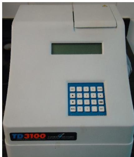
Figura 9.4 – Fluorímetro de bancada Turner Designs TD-3100 Fast Rex.
