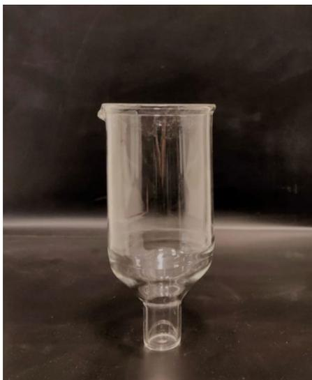
Figura 5.2 – Copo de vidro com geometria específica para ensaio de *onset* de precipitação de asfaltenos por titulação com solvente floculante e monitoramento por espectrometria de infravermelho próximo (FT-NIR).
