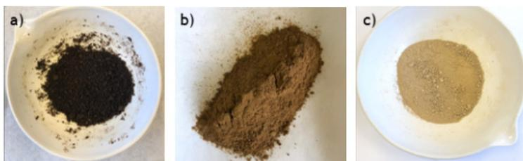
Figura 7.4 – Depósito de naftenatos: como recebido, após ter sido triturado com gral e pistilo (a); após o procedimento de remoção de excesso de óleo e posterior trituração (b); e ao final de todo o processo de purificação (c).
