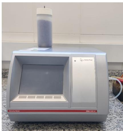
Figura 2.3 – Equipamento para análise de densidade e grau API – densímetro DMA 4500, da Anton Paar. Fonte: Autoria própria.
