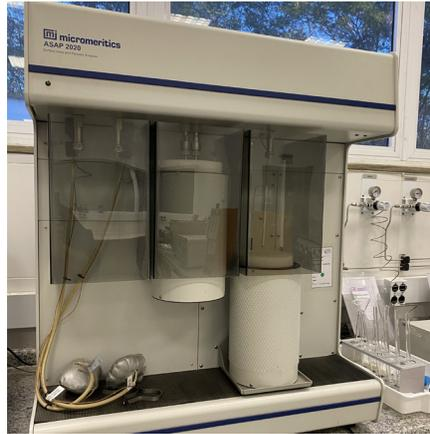
Figura 9.1 – Equipamento ASAP 2020, da Micromeritics. Fonte: Autoria própria.
