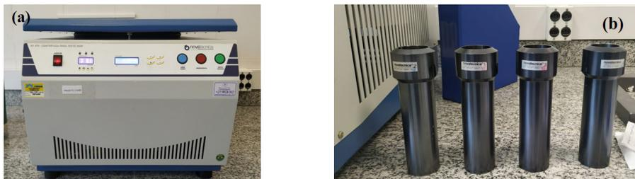
Figura 8.5 – Centrífuga BSW NT-870, da Novatécnica, utilizada para o teste de desemulsificação de emulsões (a), e rotores da centrífuga (b). Fonte: Autoria própria.
