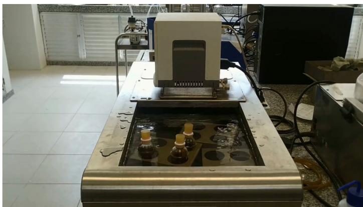
Figura 8.3 – Garrafas cilíndricas com as emulsões no banho de circulação. Fonte: Autoria própria.
