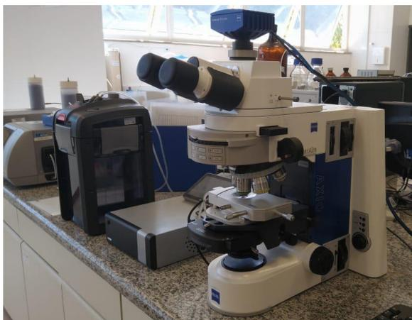
Figura 5.3 – Microscópio óptico (MO) Axio Imager A2m, do fabricante Zeiss. Fonte: Autoria própria.
