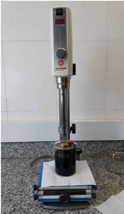
Figura 8.1 – Preparo da emulsão sintética de petróleo no agitador mecânico Polytron. Fonte: Autoria própria.
