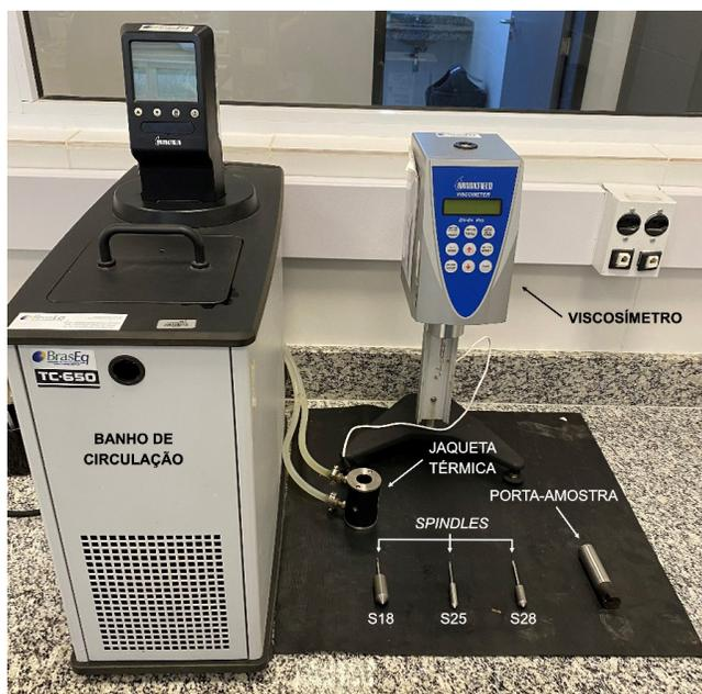
Figura 2.2 – Viscosímetro Brookfield DV-II+ Pro acoplado com banho de circulação para controle de temperatura.
